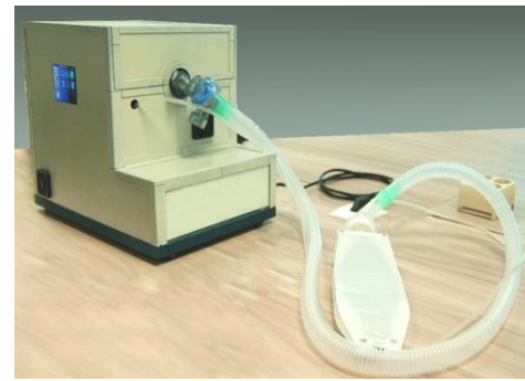
Gambar 1. Prototipe resusitator darurat dengan moda ventilasi VC-CMV
