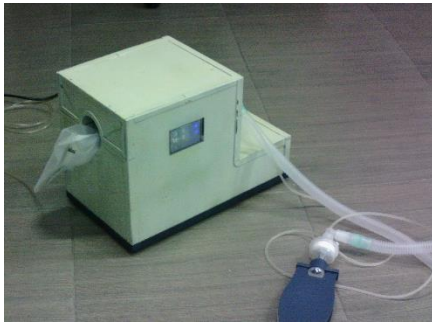
Gambar 13. Resusitator yang sedang menjalankan uji ketahanan
