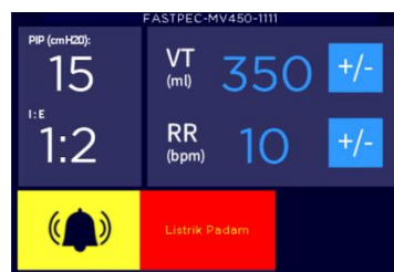
Gambar 10. Kondisi pada saat listrik padam,
