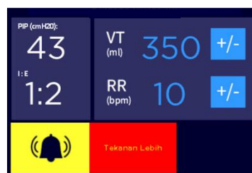
Gambar 12. Kondisi pada saat tekanan lebih
