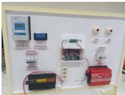
Gambar 14. Perancangan Modul PLTS Off Grid, PLTS On Grid dan Hybrid
