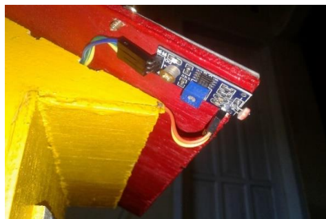
Gambar 5. Pemasangan Sensor Cahaya LDR
