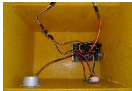
Gambar 6. Pemasangan Pin Motor Stepper
